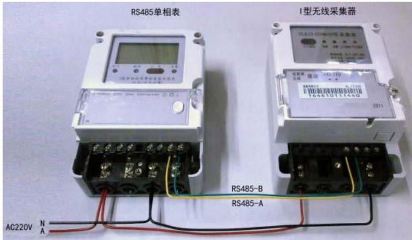
图6-6 I型采集器与DL/T645-2007 电表连接
