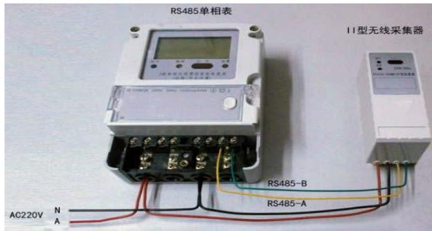
图4-8 II型采集器与DL/T645-2007电表相接
