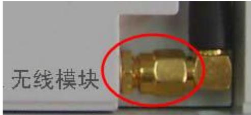
图6-1 旋紧天线与模块的连接螺母
